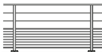
Modèle DELPHIA Multi-lisses horizontales rapprochées et vitrage 44.2 en partie inférieure
